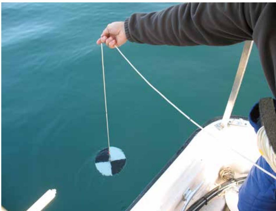
Photo 1 – Deux types de disque sont utilisés : soit un disque blanc de 30 cm de diamètre, soit un disque noir et blanc de 20 cm de diamètre (protocole DCE) (© D. Zanella – SILA)
